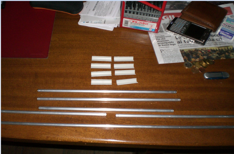
Taglio degli elementi ed isolatori
