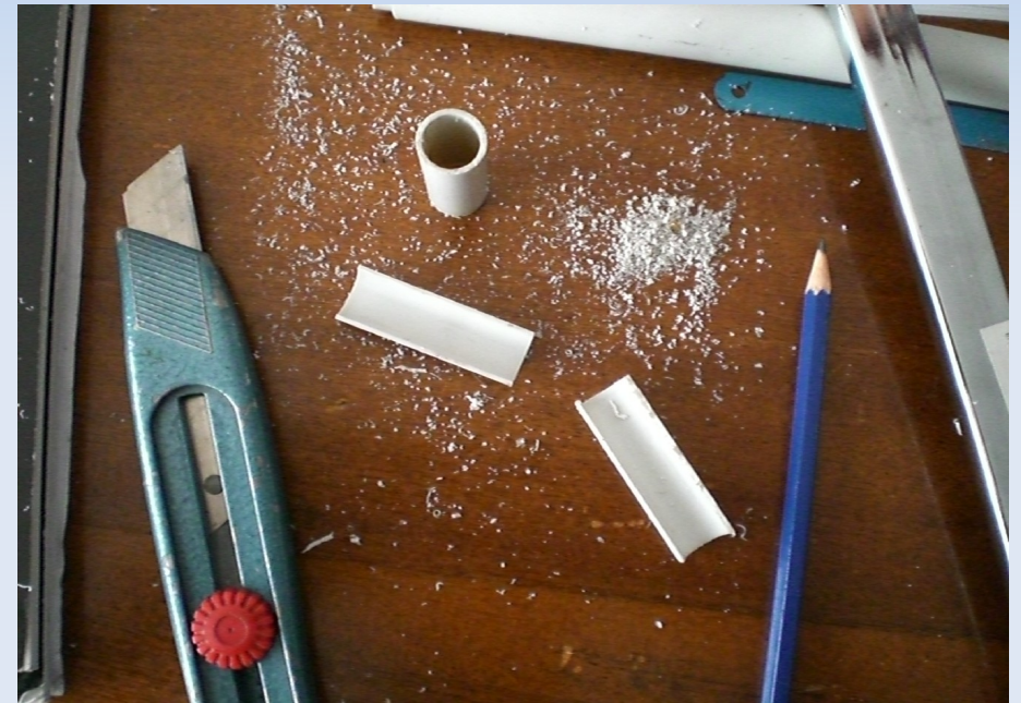
Gli isolatori fatti con tubetto 25mm per impianti elettrici (primordiali)
