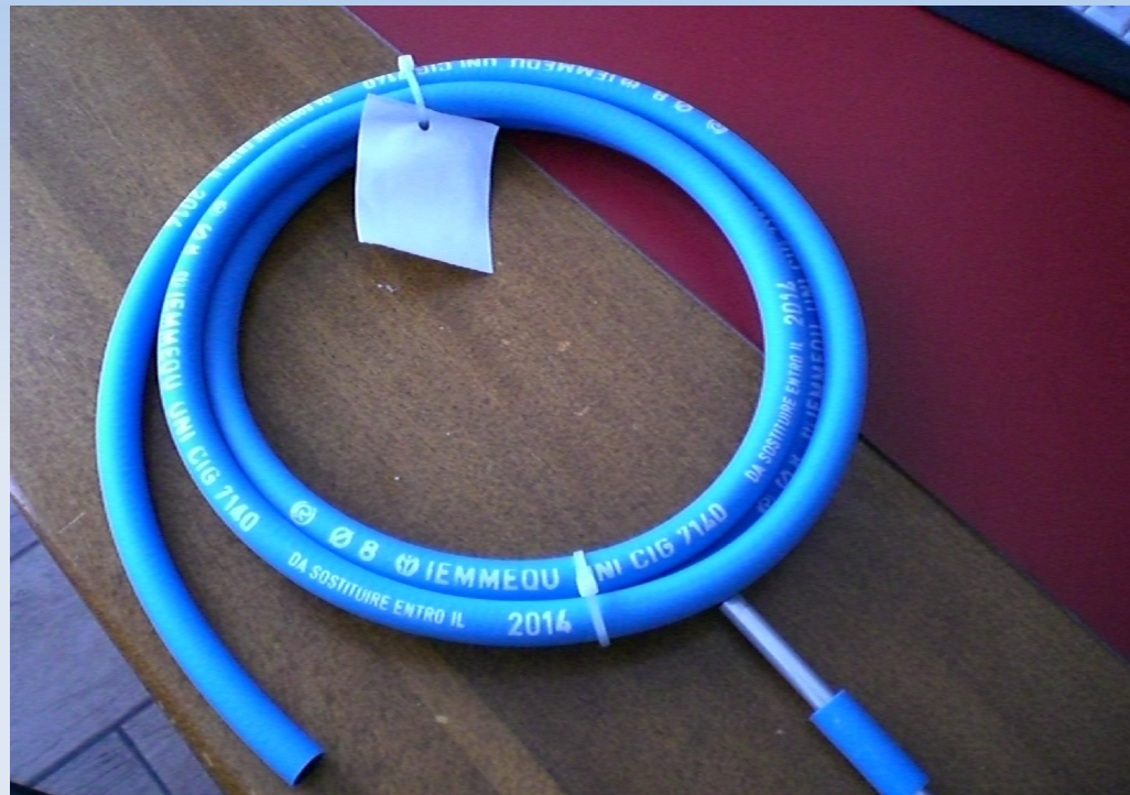
I nuovi isolatori fatti con tubo per gas del 8mm di diametro interno
